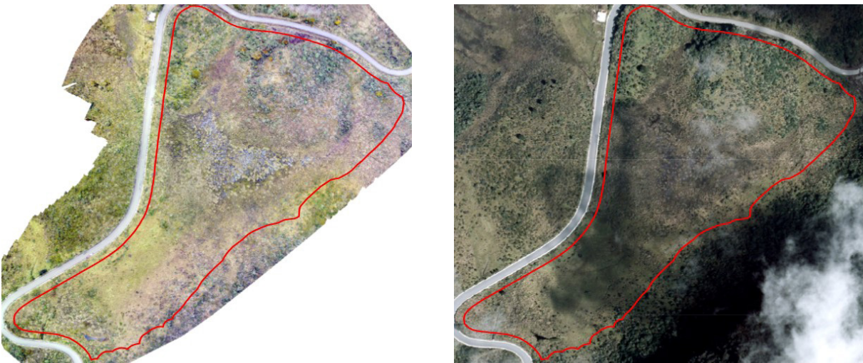
Figura 6. Comparación en color verdadero de las imágenes corregidas (ELC) de las cámaras UltraCam D (2008, izq.) y DJI Phantom (2017, mosaico, der.)
