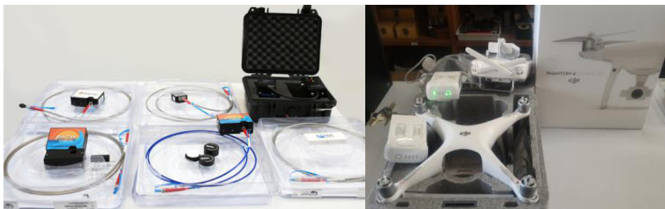
Figura 5. Fotografías de los equipos del laboratorio de espectrometría: espectrómetro (izq.) y UAV Phantom 4 Advanced (der.)
