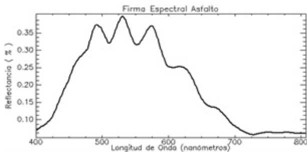
Figura 13. Firma espectral de asfalto representada en niveles de reflectancia y longitud de onda en nanómetros Fuente: elaboración propia.
