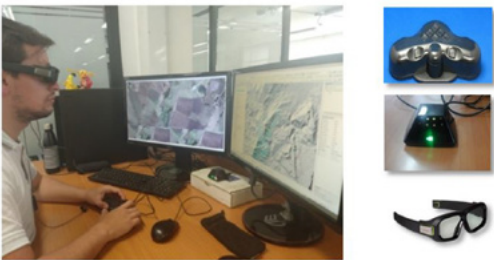
Figura 4 - Estación de trabajo para la captura de información con estereoscopia digital
